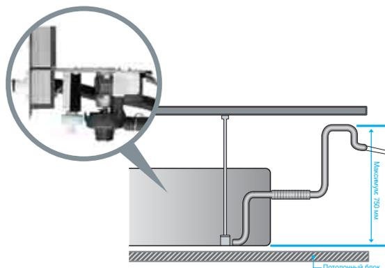
\* Максимальная высота поднятия конденсата дренажным насосом канального кондиционера HSP (22/28 кВт) и канального кондиционера с забором свежего воздуха составляет 470 мм.
